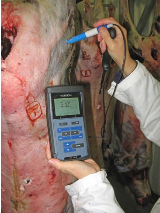
Fig. 12. Köttets pH-värde är en viktig köttkvalitetsmätning. Bilden visar pH-mätning på en slaktkropp som görs med en elektrod anpassad för kött (Foto: Eva Wiklund).
