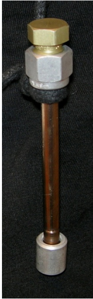
Figur 6. Perkin Elmer diffusionsrör försedd med diffusions-cap.
