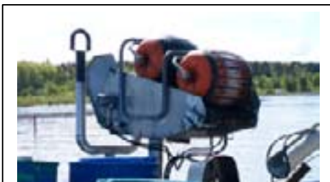
Figur 29. En modern nätrullare vid relingen hjälper till att dra långa nätlänkar från stora djup. Från vikingatiden finns uppgifter om att tvåkohorn, ett vadhorn, fyllde en liknande funktion.
