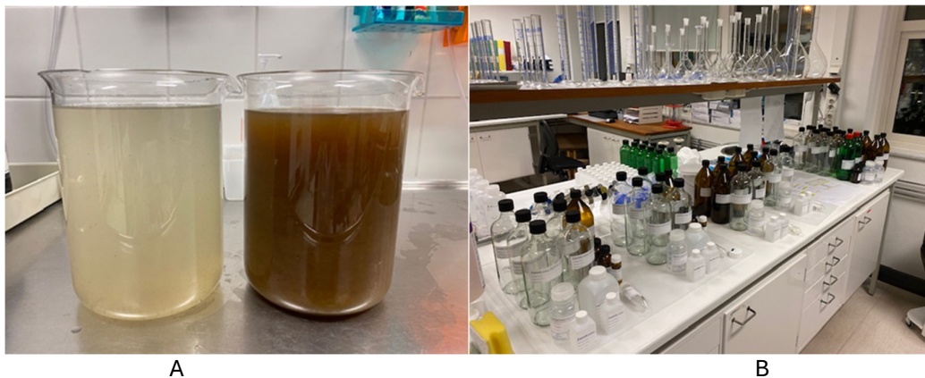
Figur 4. (A) Gråvatten (vänster) och svartvatten (höger) från provtagningsperioden. (B) Provhantering vid Öresundsverkets laboratorium vid överföring av prover till analysflaskor inför transport till externt laboratorium.
