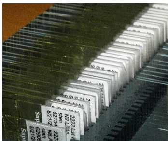
Figur 2. Kiselalgskalen prepareras fram och fixeras på objektglas. Analys görs i ljusmikroskop i 1000 gångers förstoring med oljeimmersionsobjektiv. Mikroskopet ska helst vara utrustat med interferenskontrast, vilket gör att man kan se mycket små former tydligare än med andra tekniker.
