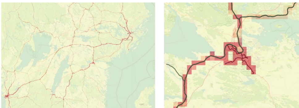
Figur 19. Fördelningsnyckel för emissioner från underhåll och nybyggnation av järn- och spårväg. Vänstra figuren visar fördelningsnyckel för norra Götaland och södra Svealand och högra figuren visar fördelningsnyckeln i området runt Norrköping. Notera för Norrköping att emissionerna fördelas både över järnväg (grön linje) och spårvagnsnätet (röd linje).
