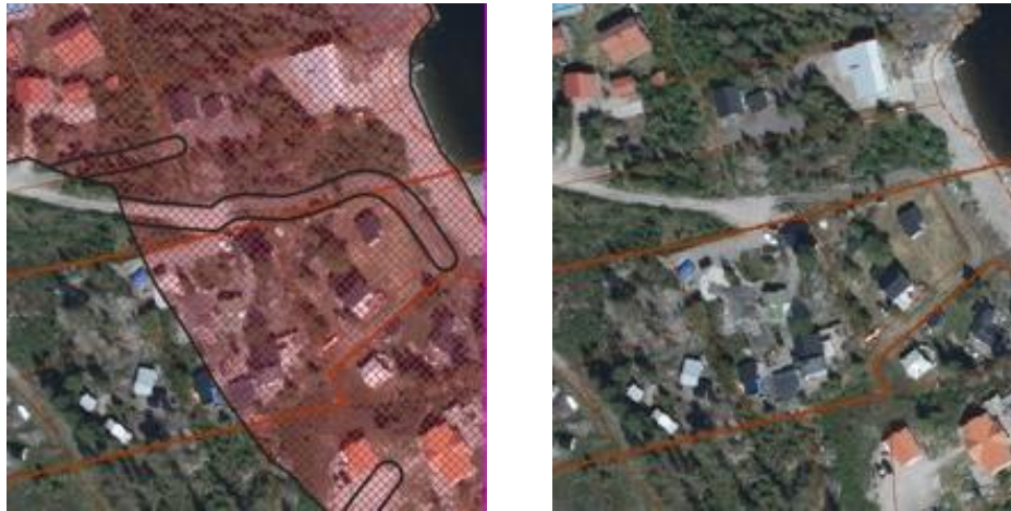
Figur 4. Exempel på rätt skattning av exploatering vid byggnader på strand vid fastlandskusten. Röd rastring motsvarar den exploaterade ytan enligt metoden. Bakgrundsbild: Ortofoto, 0,5 m ©Lantmäteriet
