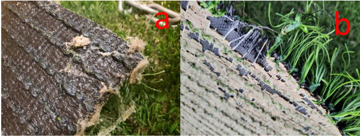
Figur 15. Foton av baksidan av två konstgräsmattor, (a) en i bruk och (b) en som kasserats av åldersskäl. Det framgår tydligt att coatingen på mattans backingen har börjat brytas ned, vilket leder till att konstgrässtråna inte längre sitter fast lika hårt i mattan.
