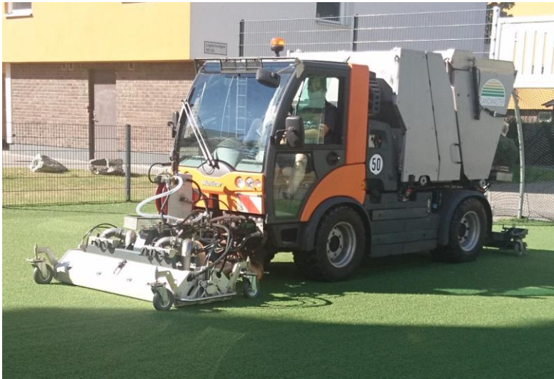
Figur 8. En tvättmaskin som användes för att tvätta ytor och samla in tvättvatten för analys av mikroplaster i studien ”Microplastics from cast rubber granulate and granulate-free artificial grass surfaces” [Olshammar 2021].
