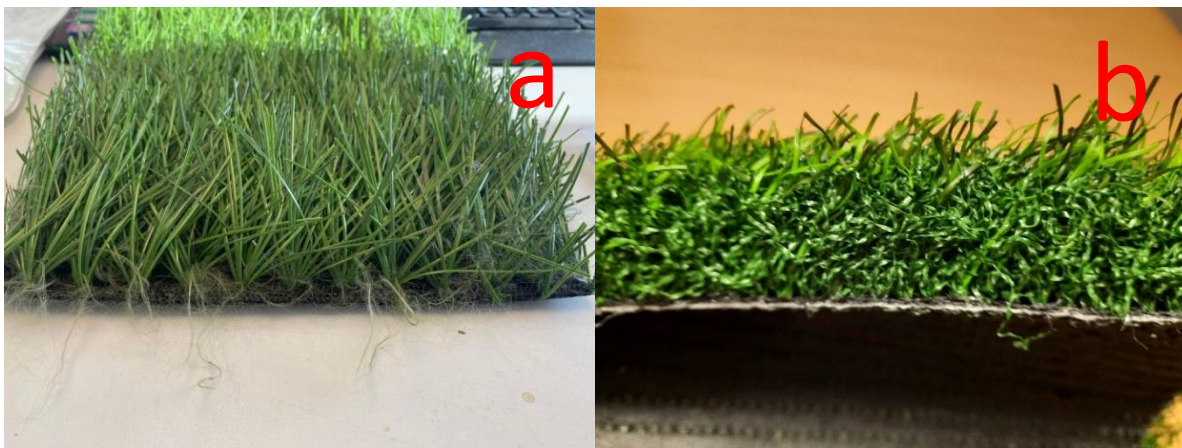
Figur 18. (a) Ett 3G-konstgräs där man ser bindgarn som håller fast buntar med 6-10 långa raka konstgrässtrån. (b) Ett 4G konstgräs, där konstgräsmattan är betydligt tätare packad än 3G mattan och har både raka och böjda grässtrån.
