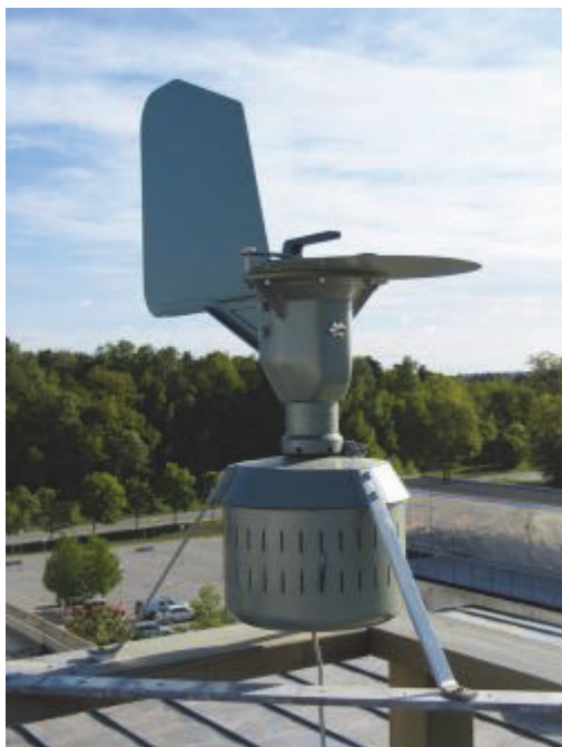
Figur 5. Bukard Seven-Day Recording Volumetric spore trap. (Foto: Hämtad från www.nrm.se )
