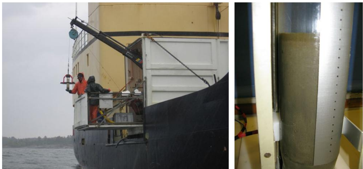
Figur B. 1) Provtagning av sediment med en Kajak-hämtare. 2) Kajakrör med sediment, på toppen syns ett skikt av ca. 1 cm med syresatt sediment.
