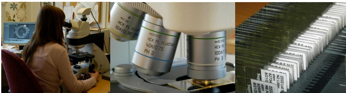
Figur 1. Kiselalgsanalys görs i ljusmikroskop i 1000 gångers förstoring med oljeimmersionsobjektiv. Mikroskopet ska helst vara utrustat med interferenskontrast, vilket gör att man kan se mycket små former tydligare än med andra tekniker, © Medins Biologi AB.
