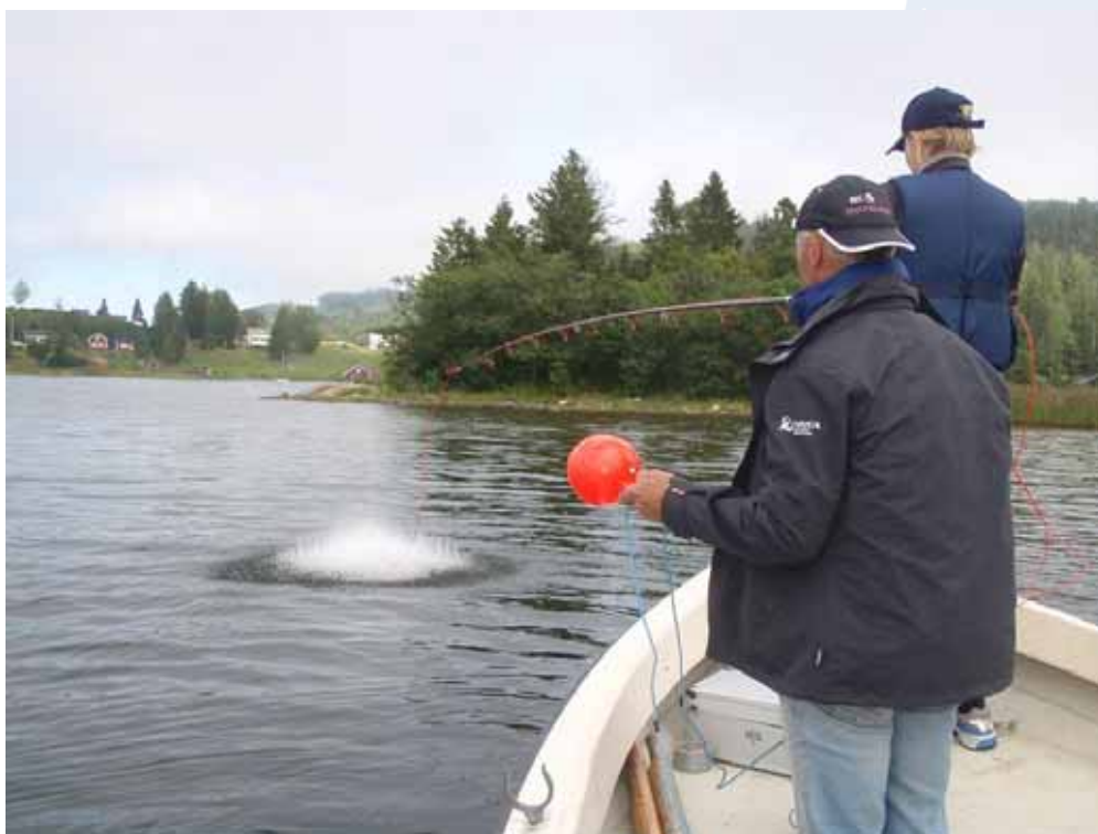
En 10 g sprängladdning fästs på ett metspö och detoneras 0,5-1 m under vattenytan. Detonationspunkten märks ut med en boj för att på ett säkrare sätt kunna finna sjunkna fiskar. Foto: Fiskeriverkets utredningskontor i Härnösand
