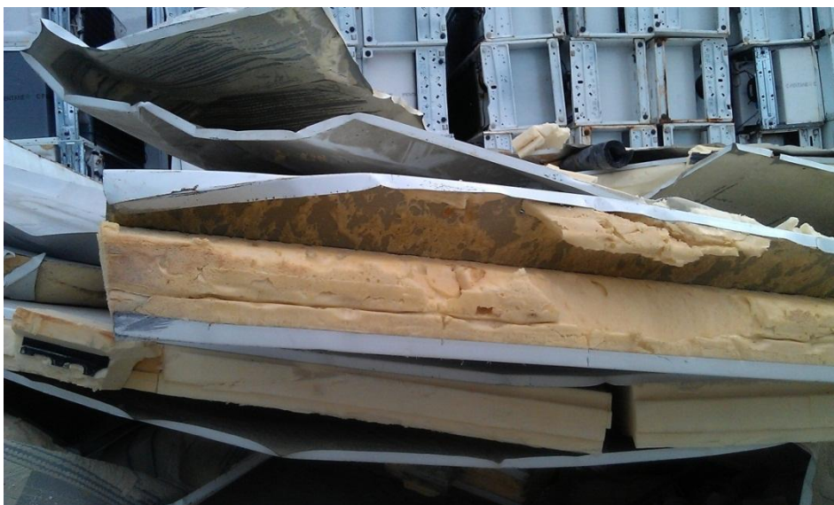
Bild 2.1. Sandwich-element med CFC-isolering
