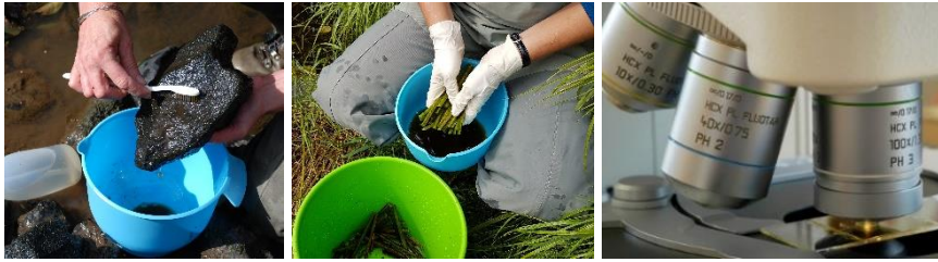
Figur 1. Provtagning av kiselalger görs i första hand från sten genom att påväxten borstas av. Om inte stenar finns eller om det t.ex. är för djupt, kan prov tas från vattenväxter genom att växtdelar som befunnit sig väl under vattnet skakas, eller "tvättas" av. Kiselalgsanalys görs i ljusmikroskop i 1000 gångers förstoring med oljeimmersionsobjektiv. Mikroskopet ska helst vara utrustat med interferenskontrast, vilket gör att man kan se mycket små former tydligare än med andra tekniker.
