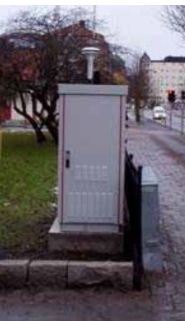
TEOM-instrument i mätskåp (foto Oleiko)
