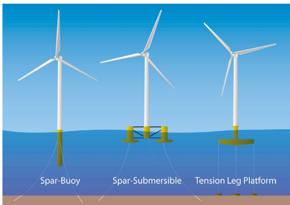
Figur 5. Olika typer av flytande vindkraftverk: Sparfundament, Spar-submersible och Tension leg platform .
