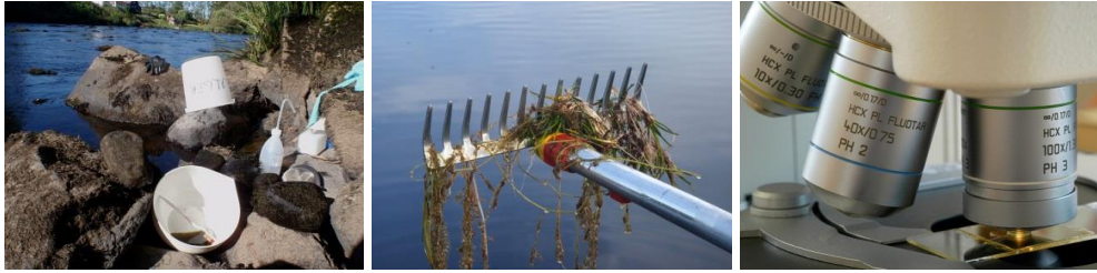
Figur 1. Kiselalgsprovtagning utförs i första hand genom att stenar borstas av. Om det inte finns stenar eller om det är för djupt för att vada, kan även vattenväxter användas som substrat. Kiselalgsanalys görs i ljusmikroskop i 1000 gångers förstoring med oljeimmersionsobjektiv. Mikroskopet ska helst vara utrustat med interferenskontrast, vilket gör att man kan se mycket små former tydligare än med andra tekniker.
