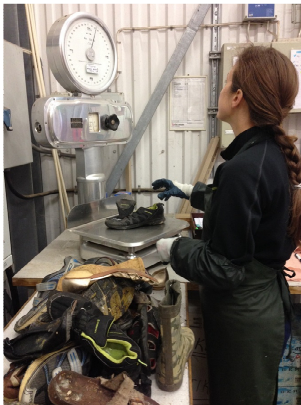
Figur 1. Vägning av skor funna i restavfall vid en av projektets plockanalyser. (Vukicevic, 2015)
